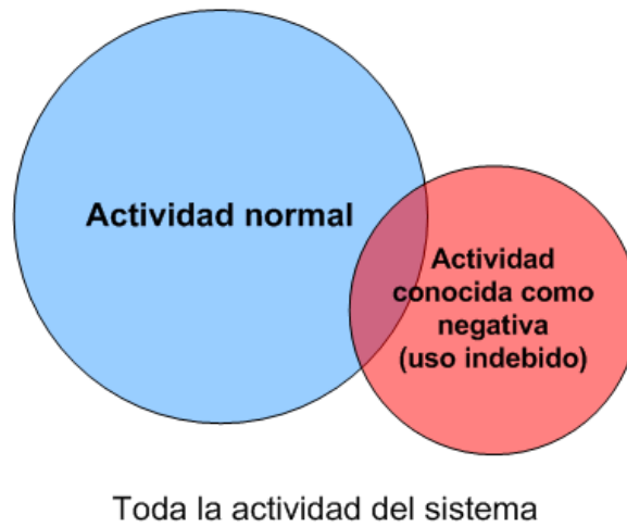
Figura 3-9 - Actividades de un sistema: usos indebidos y anomalías
